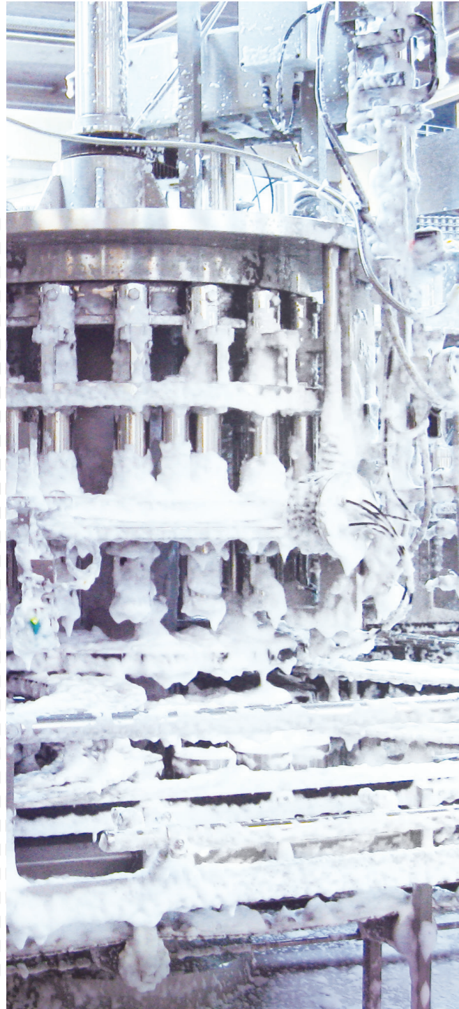
Limpeza con espuma instalación de llenado
