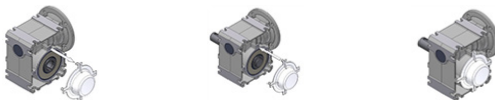
Illustration 14: Afmontering og montering af afdækningshætter
