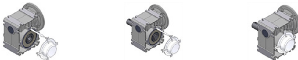
Εικόνα 14: Αποσυναρμολόγηση και συναρμολόγηση του καλύμματος
