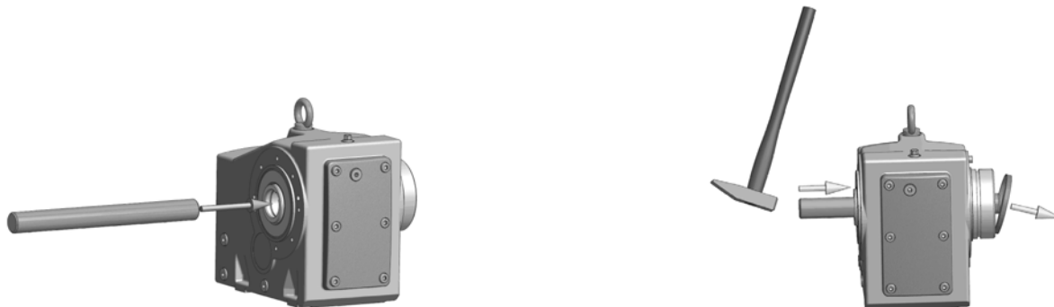
Фигура 5: Демонтаж на монтирания в завода затварящ капак
