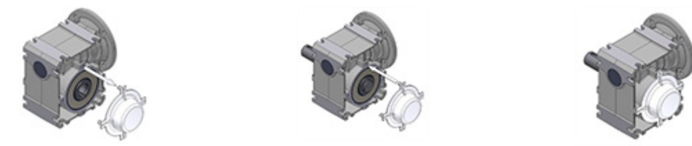
Фигура 14: Демонтаж и монтаж на предпазния капак
