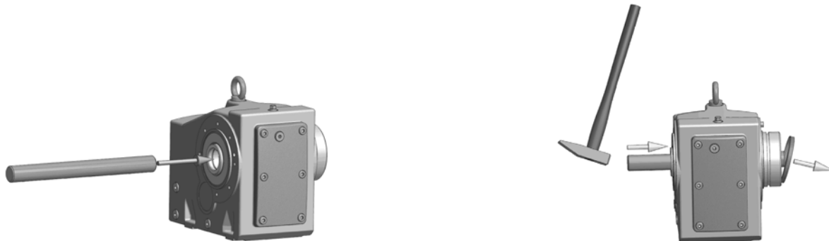
図 5: 工場出荷時に取り付けられたシーリングキャップの取外し
