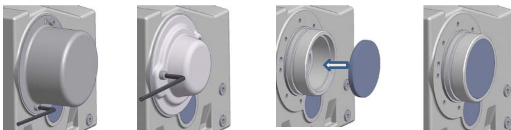
図 14: オプション SH、オプション H、オプション H66 のカバーフードの取付け
